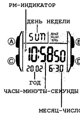
На рисунке изображен общий вид часов в Режиме Текущего Времени. Нажмите кнопку "C" для перехода из режима в режим в следующей последовательности:
